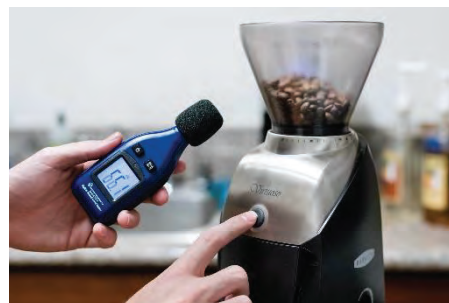
Μέτρηση της έντασης του ήχου που κάνει ένα πιστολάκι και ένας μύλος καφέ με ηχώμετρο
