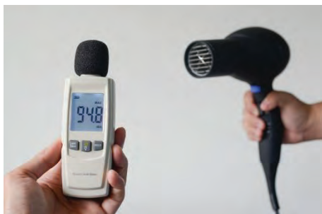
Μέτρηση της έντασης του ήχου που κάνει ένα πιστολάκι και ένας μύλος καφέ με ηχώμετρο
